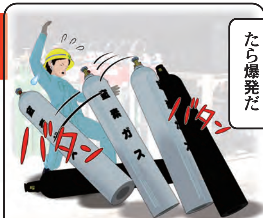
転倒・重量による物損/けが バルブの破壊
